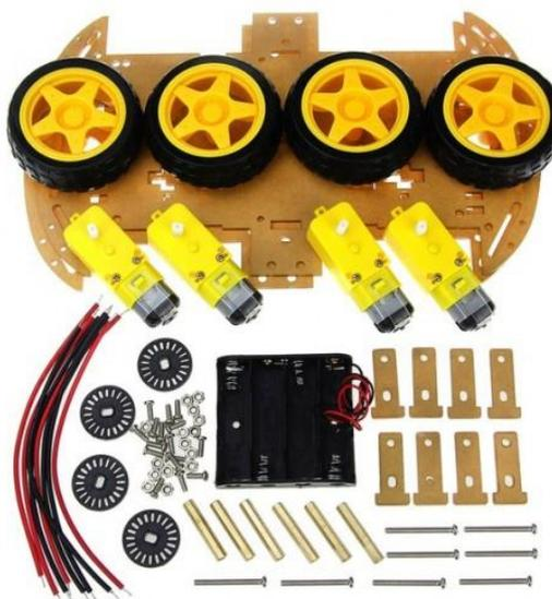
Рисунок 2.1 – Сборочное шасси и компоненты.
